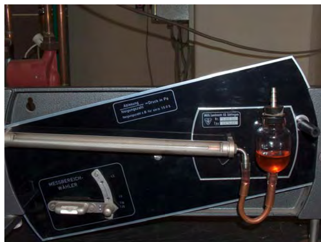
A nyomáskülönbség-mérésre használt ferdesöves manométer
